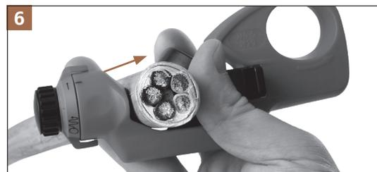
Für Längsschnitt Stelling auf das Symbol Längsschnitt (→) umstellen und Gerät axial in Längsrichtung ziehen
