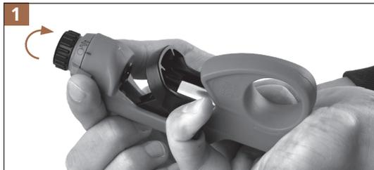
Abisoliergerät entsperren durch Drehen vom Stelling auf das Symbol Rundschnitt (↻)
