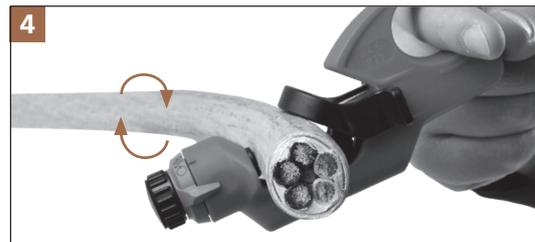
Gerät auf die Markierung der Abisolierlänge aufsetzen und den Rundschnitt durchführen
