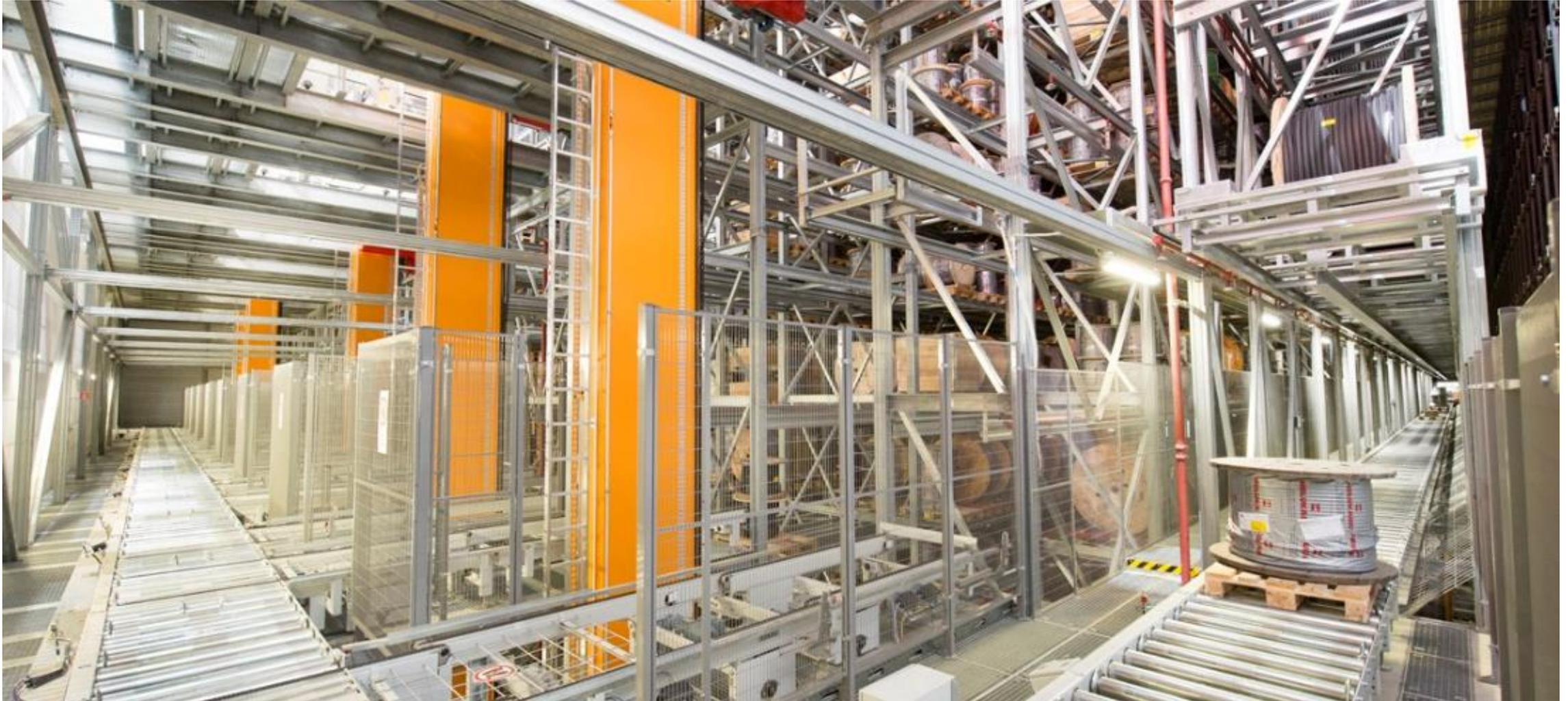
Entrepôt à hauts rayonnages: le convoyeur se connecte directement aux ateliers de coupe de câbles
