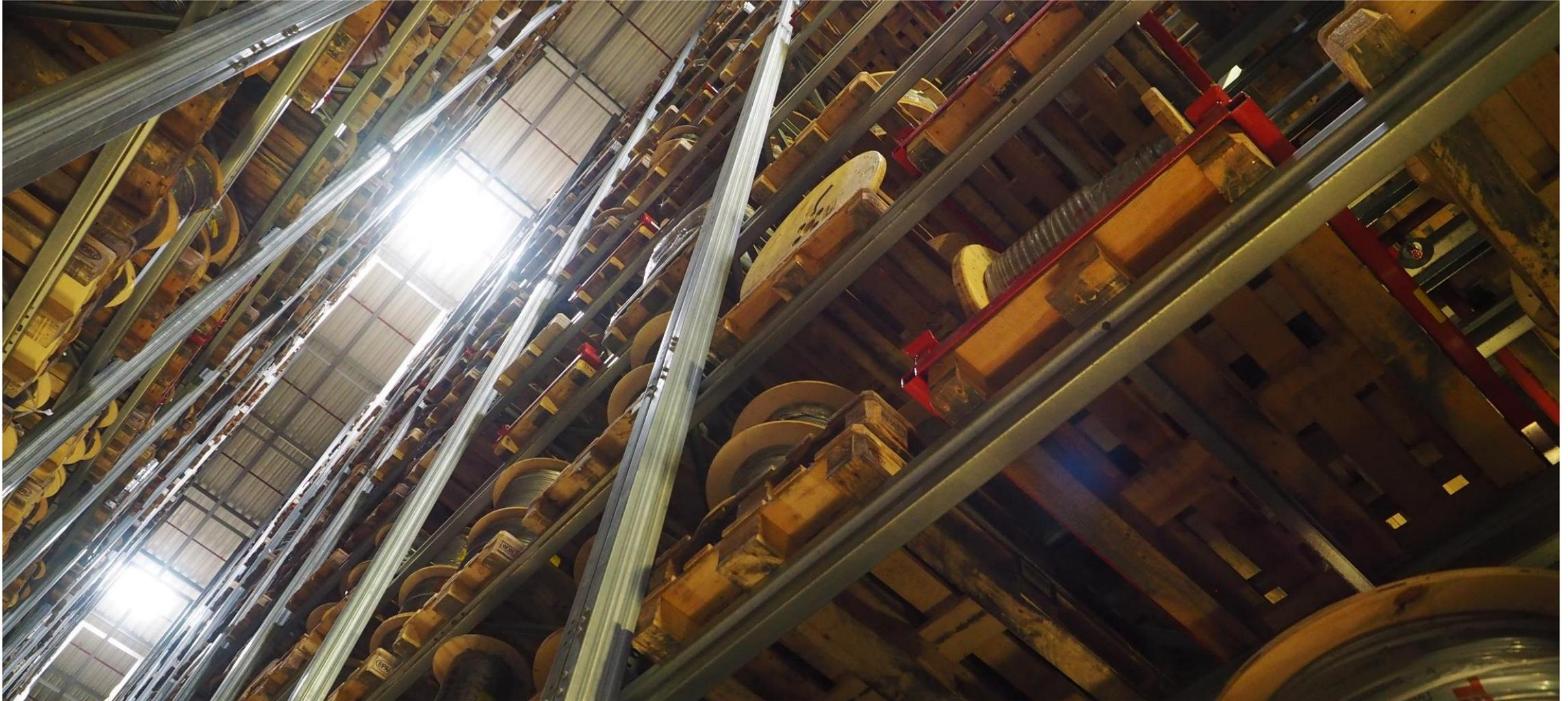
Entrepôt à hauts rayonnages: Il y a 670 emplacement pour tourets à «haute rotation» (pesant jusqu'à 4 000 kg avec un diamètre de 2,2 m)
