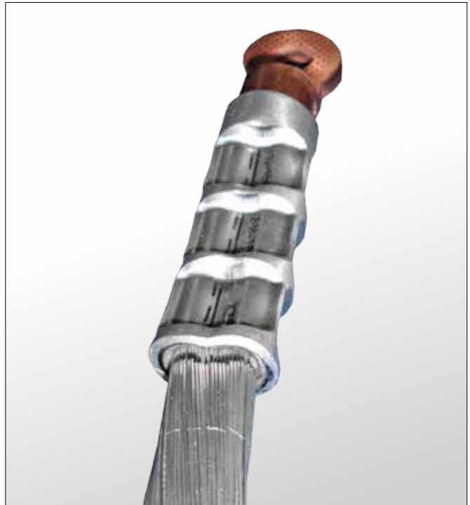
Der C8-Crimp: Die ausgeprägte Tiefenkontur verbindet den Presskabelschuh und den feindrätigen Aluminiumleiter zu einem massiven Konstrukt.
