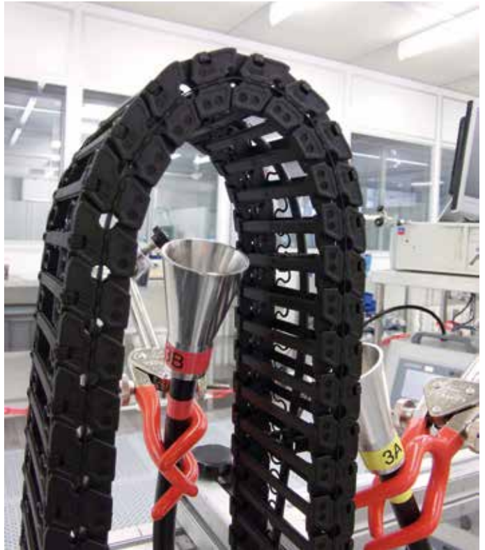
Test der HELUKABEL® CLEANFLEX®-Leitungen unter Reinraum Bedingungen
