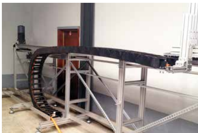
6 m Schleppkettentestanlage für große Querschnitte
