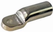
HELU-S-PK-AL-FG-VZN Aluminium, verzinkt, FG, extrudiert, gerade Ringform Art.-Nr. 909853
