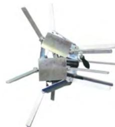
Abb. 2 RAPID 450 SP geklappt zur Ringentnahme
