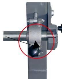
Abb. 3 Backenbremse
