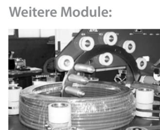
Abb. 8 Einwickelstation für Stretchband
