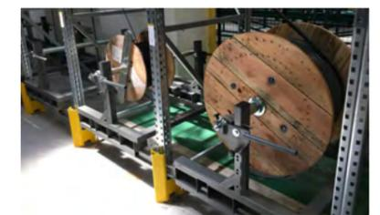
Abb. 3 TROMTRAK 1000 Ablaufgeräte im Einsatz
