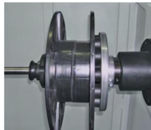
Abb. 3 Spulwickelachse
