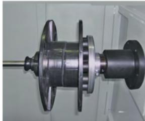
Abb. 3 Spulwickelachse
