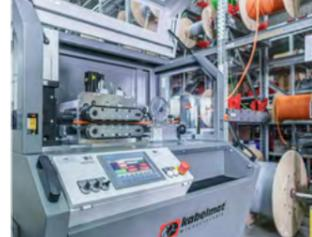
Abb. 3 Bedienpult mit Touchpanel-Steuerung und geregeltm Positionier-Servoantrieb
