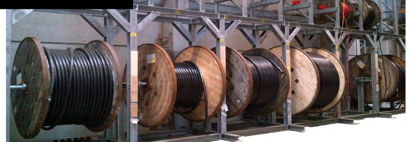
Abb. 1 ABROL Schwerlasttrommellager und Abwickelsystem mit LAGROL kombiniert
