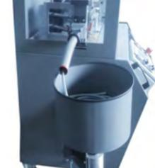
Abb. 5 Topfwickler mit regelbarem Antriebsmotor
