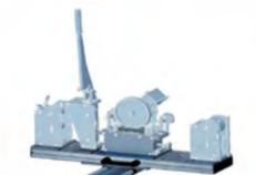
Abb. 7 Aluprofil mit MESSBOI 40 BAE, MATIS 40 und Ein- und Auslaufrollenkäfigen
