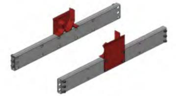
Abb. 9 Achsaufnahmepaar o. Bremse (3 Pos.) für einzelne Trommelbelegung
