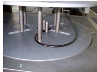
Abb. 4 Kabelklemmung des Wickeltellers
