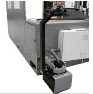
Abb. 4 Fahrtrieb mit Steuerdeichsel
