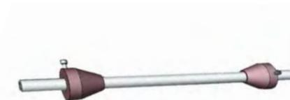
Abb. 3 Trommelachse mit Zentrierkonen
