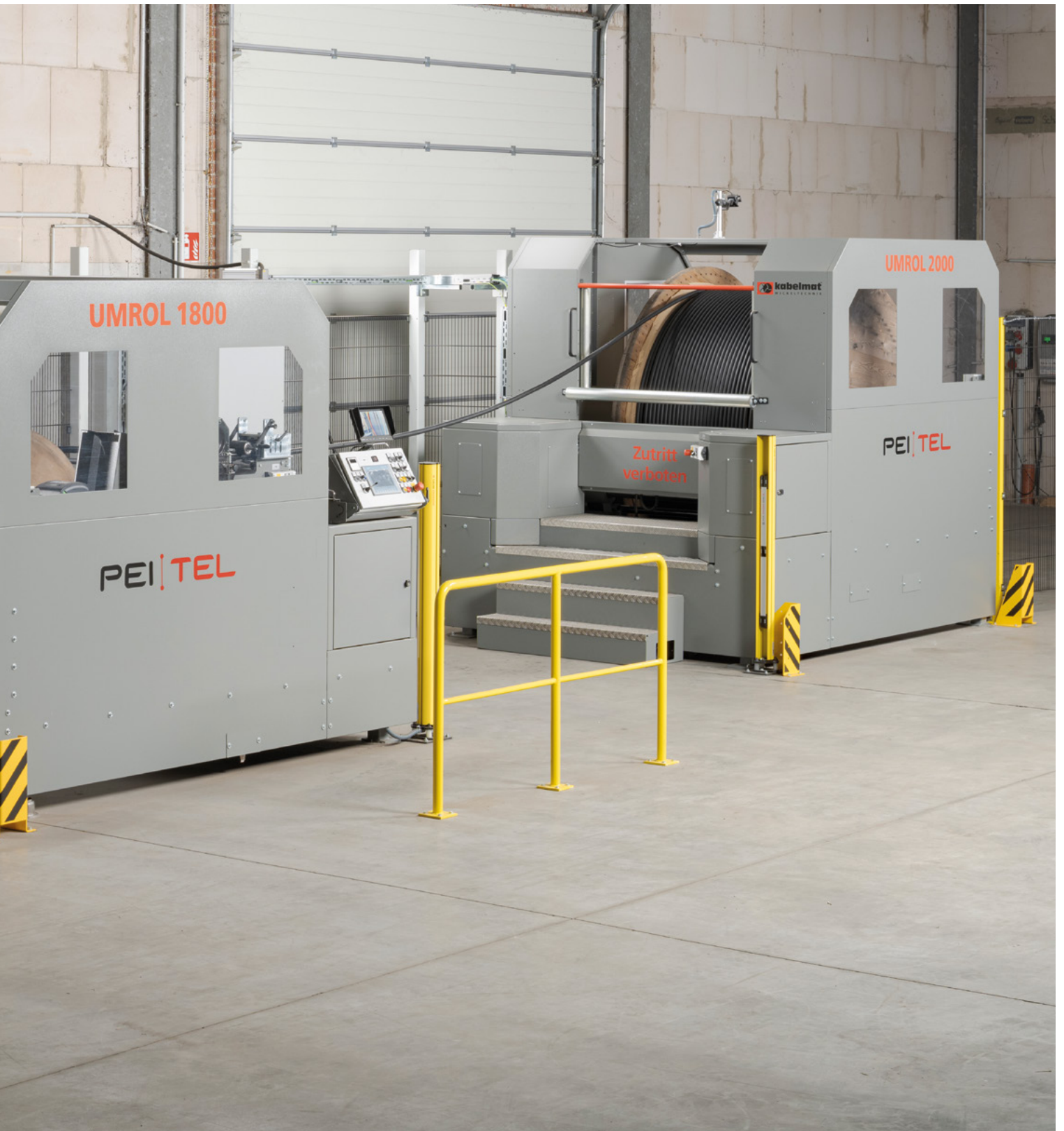
Eine automatische Umwickellinie von KABELMAT ermöglicht bei pei tel ein schonendes Handling empfindlicher Kabel.
