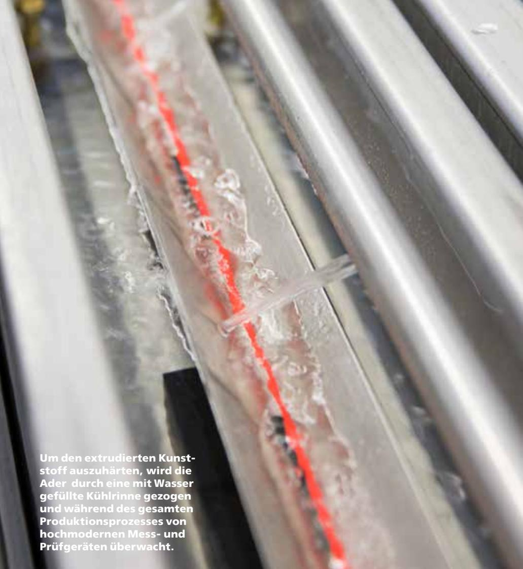
Um den extrudierten Kunststoff auszuhärten, wird die Ader durch eine mit Wasser gefüllte Kühlrinne gezogen und während des gesamten Produktionsprozesses von hochmodernen Mess- und Prüfgeräten überwacht.
