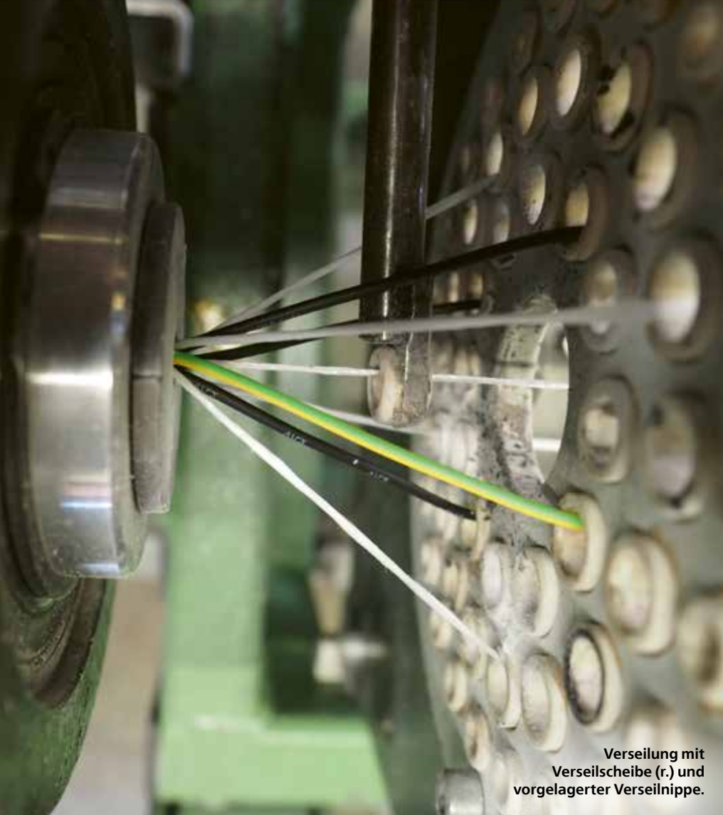
Lagenverseilung im Gegenschlag an einer Korb- verseilmachine.
