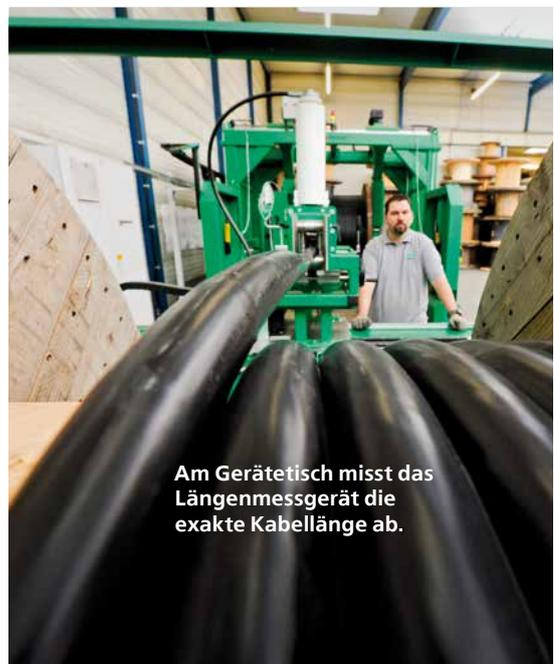
Am Gerätetisch misst das Längenmessgerät die exakte Kabellänge ab.
