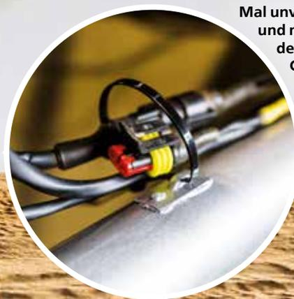
**Mal unverrückbar fixiert, mal locker und mit Spiel gehalten: Kabelbinder führen alle Kabelbäume am Chassis entlang, geben Halt, wenn es rüttelt, und lassen Luft, wo eine zu starre Fixierung zu Schäden führen könnte.**
