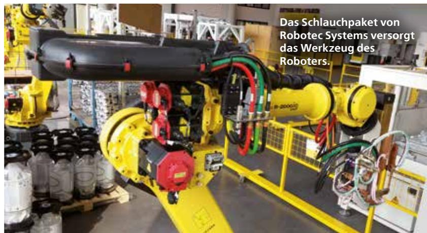
Das Schlauchpaket von Robotec Systems versorgt das Werkzeug des Roboters.
