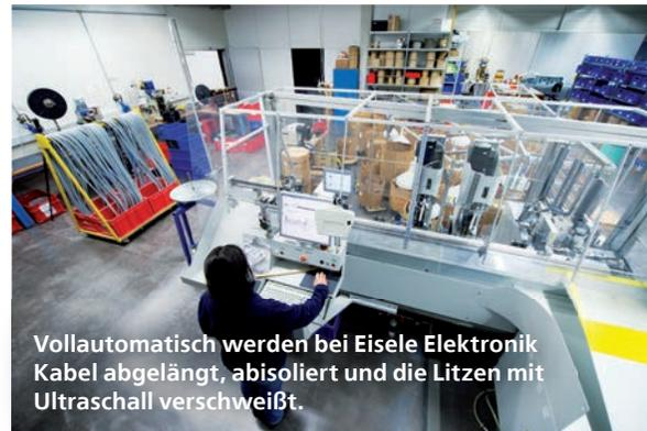
Vollautomatisch werden bei Eisele Elektronik Kabel abgelängt, abisoliert und die Litzen mit Ultraschall verschweißt.
