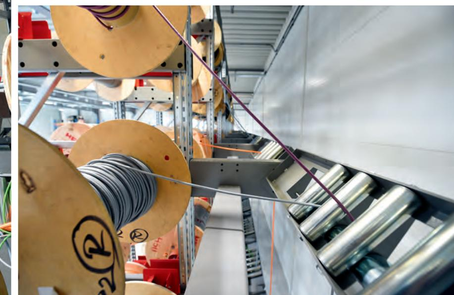
Jedes Kabel wird beim Herunterziehen über eine Umlenkrolle zum Bediener geführt – so kommen sich die Leitungen beim Ablängen nicht in die Quere.
