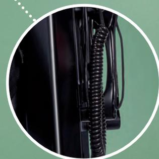
Ein Spiralkabel von HELUKABEL verbindet die Fernbedienung mit dem Exoskelett.
