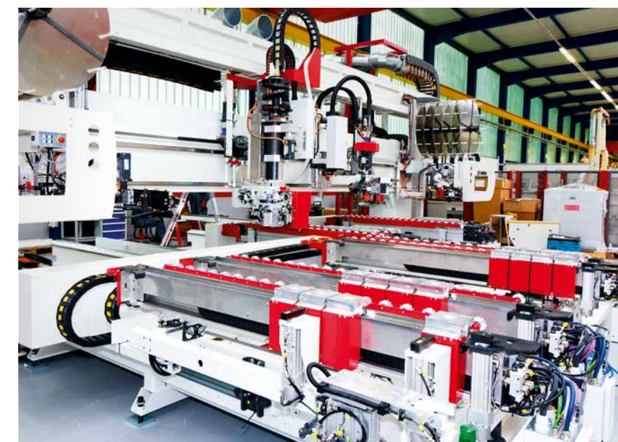
Bei ihren Holzbearbeitungsmaschinen setzt IMA auf die Einkabeltechnologie.
