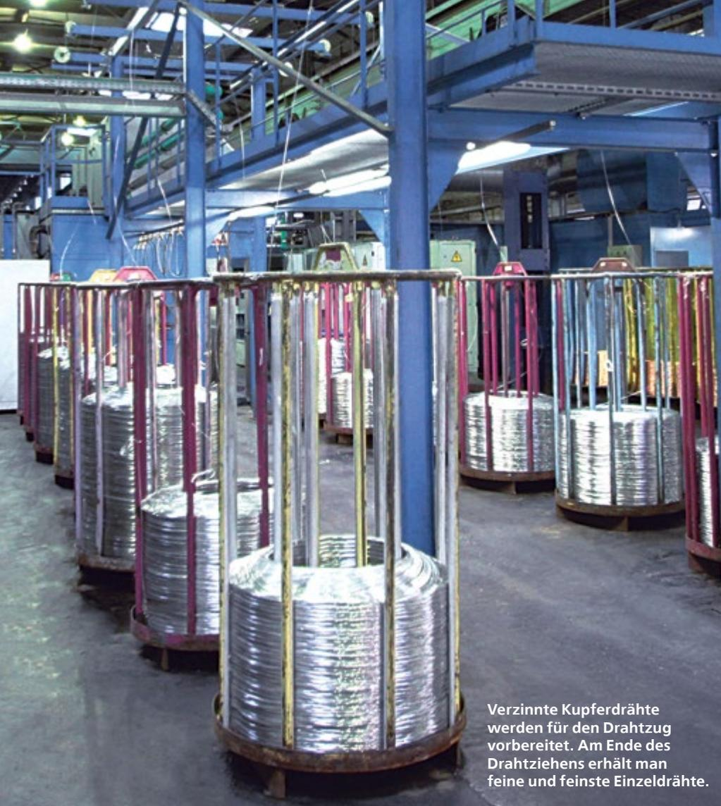
Verzinnete Kupferdrähte werden für den Drahtzug vorbereitet. Am Ende des Drahtziehens erhält man feine und feinste Einzeldrähte.
